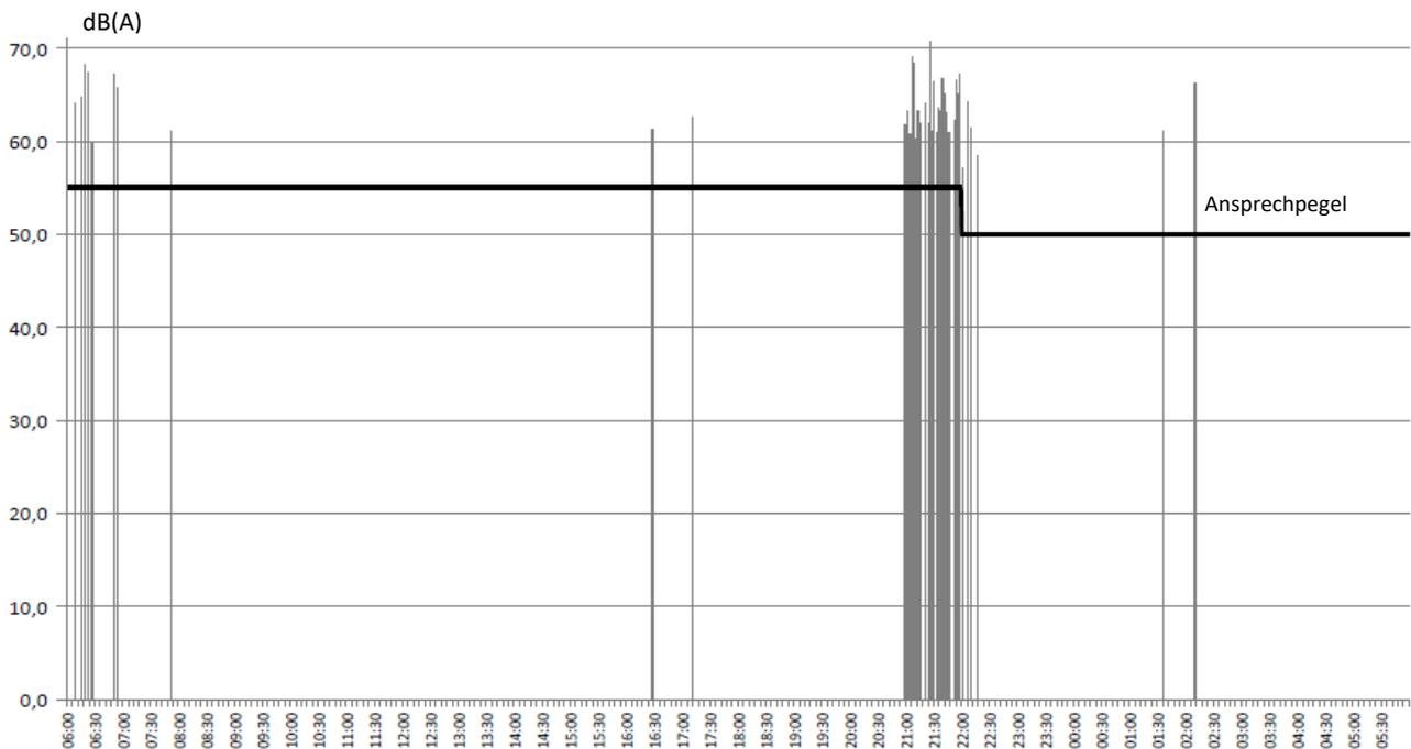
Abb. 13: Verteilung des Maximalpegels bei östlichen Winden
