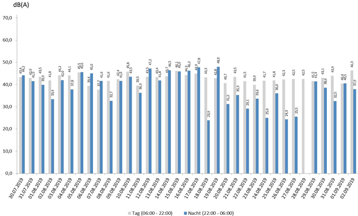
Abb. 11: Verlauf der über den Meßzeitraum gemittelten Stunden-LEQs für Flugverkehr
