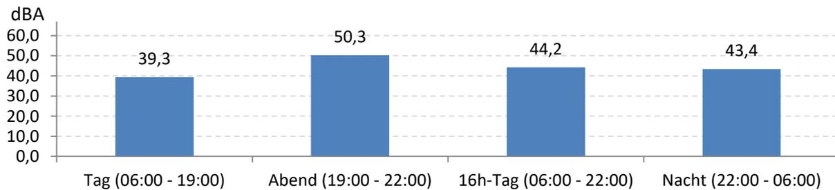
Abb. 8: LEQ bei Pistenbetriebsrichtung "Windstille" 243 Stunden im Messzeitraum
